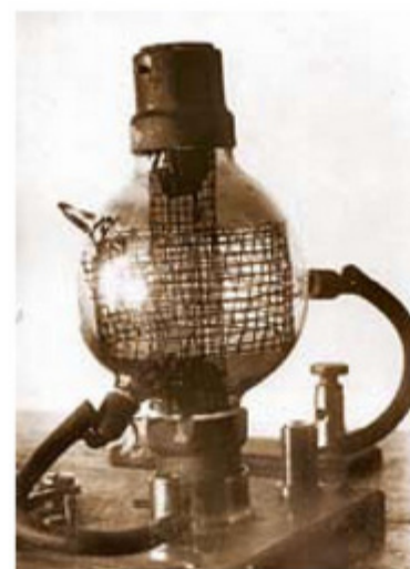
Первая российская пустотная радиолампа («Лампа-Бабушка») конструкции М.А. Бонч-Бруевича. Тверь. 1917 год
