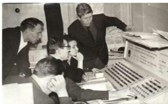
Сдача в эксплуатацию электронно-вычислительной машины БЭСМ-4. На фото С.Г. Кузин, Э.Л. Рубцова и др.
